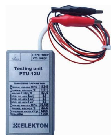
Прибор предназначен для имитации подключения погружных блоков ТМСП или ТМСПС и ТМСПР к наземным блокам и ТМСН-12-У(РН, БН, ГП) систем погружной телеметрии ЭЛЕКТОН-ТМС или ЭЛЕКТОН-ТМСР с целью проверки работоспособности наземного блока ТМСН и правильности настройки соответствующих входов контроллеров станций управления погружными электронасосами.
