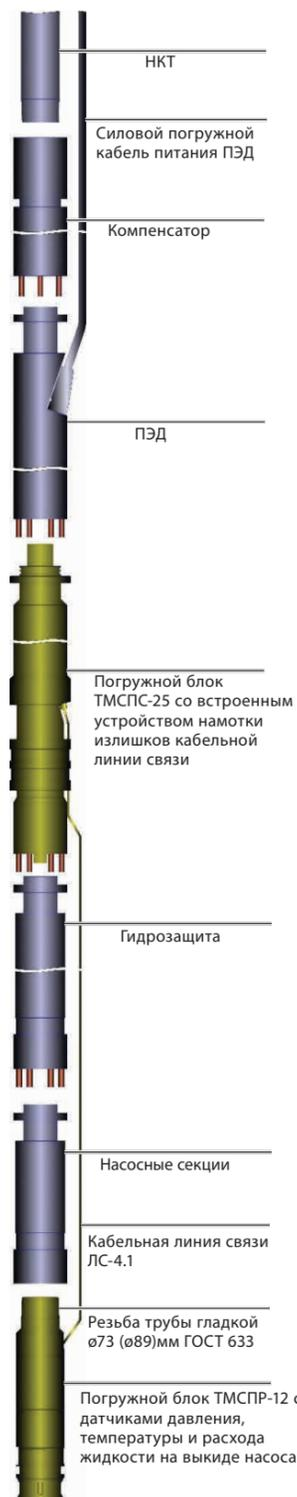
**Система погружной телеметрии ТМСР-25 предназначена для регистрации и передачи внешним устройствам текущих значений следующих параметров:**
