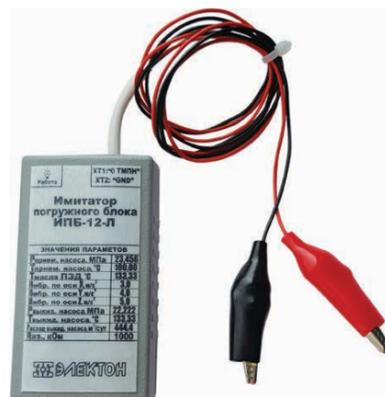
Прибор предназначен для имитации подключения погружных блоков ТМСП или ТМСПС и ТМСПР к наземным блокам ТМСН-12-Л, и ТМСН-12А-Л систем погружной телеметрии ЭЛЕКТОН-ТМС или ЭЛЕКТОН-ТМСР с целью проверки работоспособности наземного блока ТМСН и правильности настройки соответствующих входов контроллеров станций управления погружными электронасосами.
