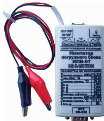
Прибор предназначен для имитации подключения погружного блока ТМСП к наземному блоку ТМСН-7 системы погружной телеметрии ЭЛЕКТОН-ТМС с целью проверки работоспособности наземного блока ТМСН и правильности настройки соответствующих входов контроллеров станций управления погружными электронасосами.
