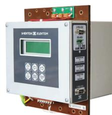
Наземный блок «ЭЛЕКТОН-ТМС-12Д» (модификация с ЖК дисплеем и клавиатурой)
