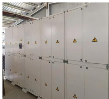
**Испытательный стенд предназначен для тестирования и силового испытания станций управления двигателями насосных, вентиляторных и других агрегатов. Стенд позволяет испытывать и тестировать станции управления в любых режимах, таких как: прямой пуск, плавный пуск, частотно-регулируемый для асинхронных двигателей и других устройств на основе инвертора напряжения.**
