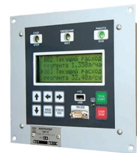
Контроллер серии «УДР-12» предназначен для работы в составе установки для дозирования реагента (УДР) – установки для регулируемой подачи химических реагентов в затрубное пространство нефтяных скважин, а также в трубопровод сбора нефти.
