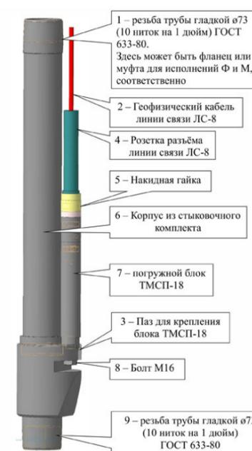
Система погружной телеметрии Электрон-ТМС-18, предназначена для работы в составе штанговых насосных установок (ШНУ), станков-качалок или в фонтанирующих скважинах и предназначена для регистрации и передачи внешним устройствам текущих значений следующих параметров:
