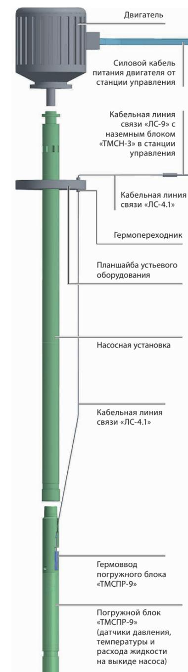
Система погружной телеметрии «ЭЛЕКТОН-ТМСР-9» предназначена для регистрации и передачи в контроллер станции управления электродвигателем погружного насоса значений параметров:
