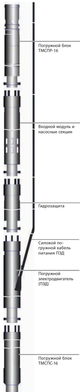
**Основная область применения:** автоматизация режимов работы электроприводов нефтедобывающего оборудования. ТМСР-16 предназначена для контроля следующих параметров:
