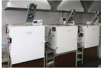
**Испытательный стенд ИС-05.1 предназначен для проведения приемодаточных испытаний блоков ТМСП, ТМСР в составе систем погружной телеметрии «Электон-ТМС», «Электон-ТМСР», в том числе на воздействие внешнего давления на корпус погружных блоков при гидроиспытаниях.**
